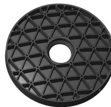
图2 主镜轻量化结构示意图
