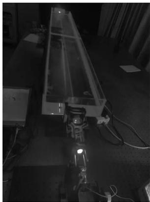
图 10 光学天线水下测试装置
