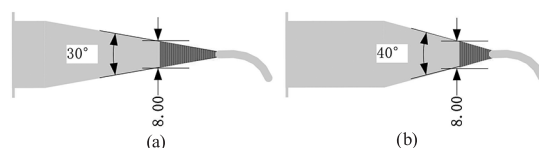
图7 30^\circ 与 40^\circ 锥腔示意图
