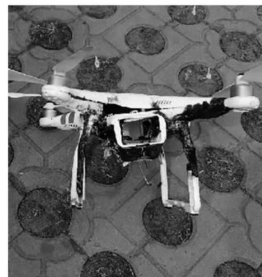
图 15 无人机毁伤效果 (距离  $300 \text{ m}$ 、速度  $5 \text{ m/s}$ )
