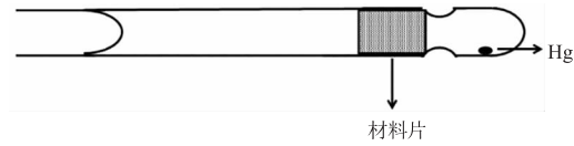
图 1 石英管内材料片与 Hg 位置示意图 [7]
