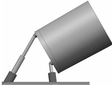
图3 三推杆伺服系统大转角示意图
