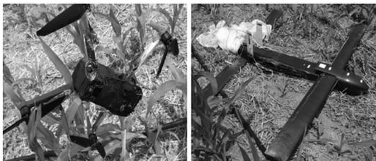
图 3 激光毁伤无人机效果图
