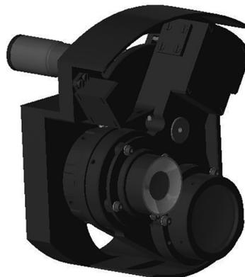
图 5 变 F 数切换机构 3D 模型图
