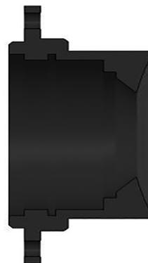
图 4 球面反射温阑结构
