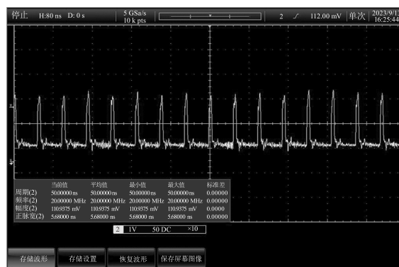
(d) 重复频率20 MHz, 脉宽5.6 ns 图5 MHz重复频率1064 nm大功率激光器测试波形图
