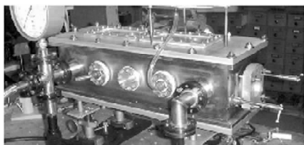
图 8 低温射频放电激励板条 CO 激光器示意图
