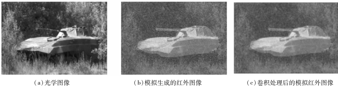
图4 基于高斯型点扩展函数对模拟红外图像的处理效果
