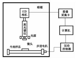
图 2 "推扫式" HSI 系统组成
