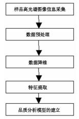
图 3 高光谱图像数据分析流程
