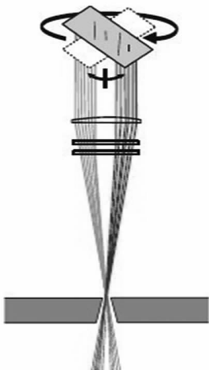
图 1 Haas 公司的平行平板摆动产生横向位移实现锥孔原理
