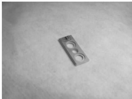
图6 铜微通道热沉封装的 CW 50W mini-bar
