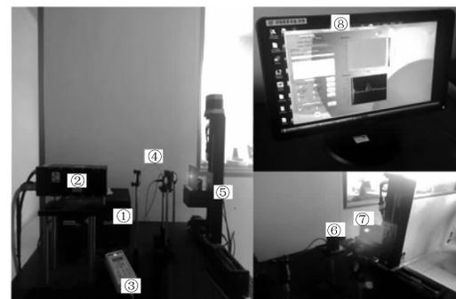
①零差干涉仪 ②激光器 ③手动控制器 ④导光镜 ⑤位置移动装置
