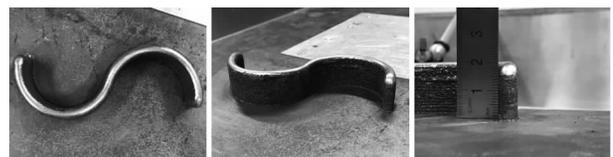
图 14 熔池宽度控制下 40 层工件成形效果
