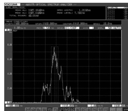
图8 LD同向偏振双端泵浦 $Tm:YLF$ 激光器输出光谱图
