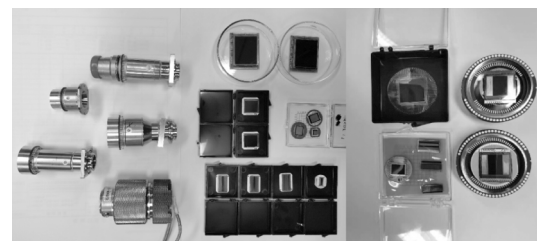
图 3 引线键合强度试验样品照片
