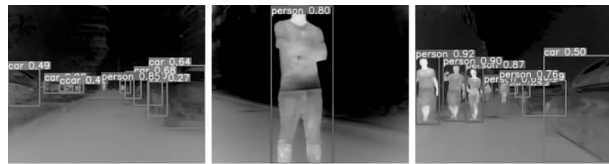
图9 红外图像障碍物检测结果
