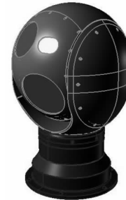
图 1 光电云台结构示意图
