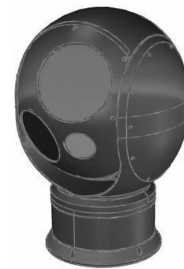
图7 隐身设计后设备结构示意图
