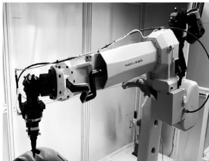
图2 激光切割机器人示意图
